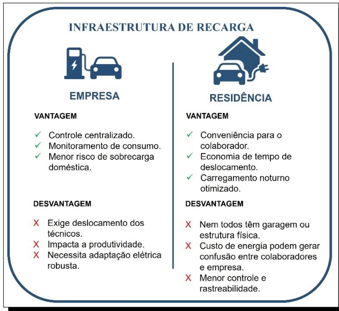
Figura IX.3: Infraestrutura de Recarga Empresa X Residência. Fonte: Autores (2025) .
